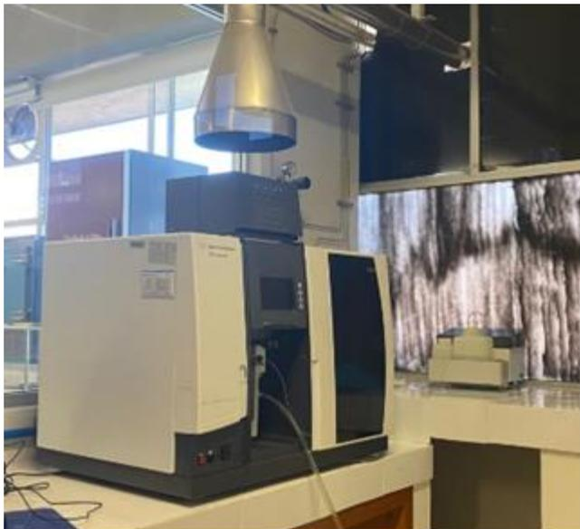
Fig.11. Espectrofotómetro de absorción atómica modelo Agilent Technologies, 200 series AA
