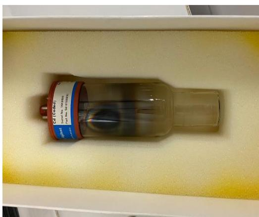
Fig. 12. Modelo de lámpara Agilent Technologies de cadmio utilizada.
