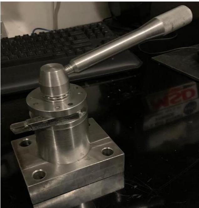
Fig. 9. Portaherramientas terminado.
