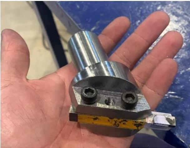
Fig. 4. *Fly cutter* terminado.
