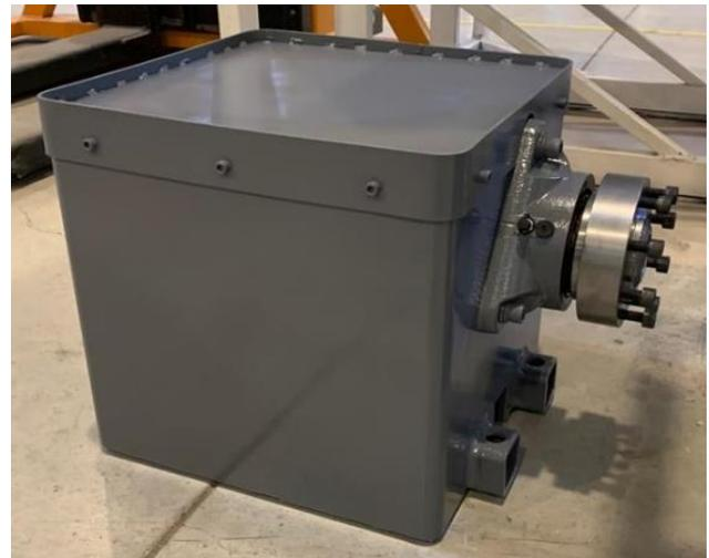
Fig. 11. Cabezal terminado con chumaceras y eje.
