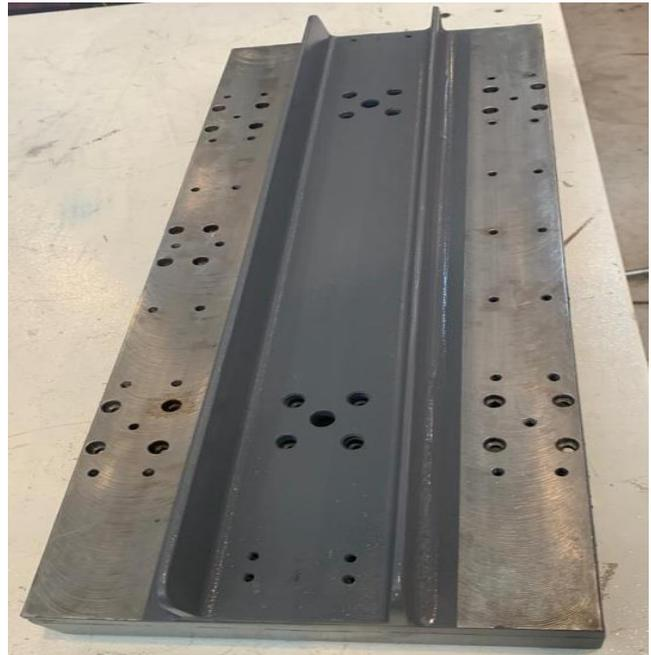
Fig. 6. Carro terminado con perforaciones, machuelados y refuerzos.
