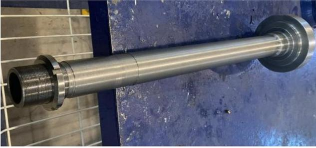
Fig. 12. Eje maquinado en torno sin perforaciones.
