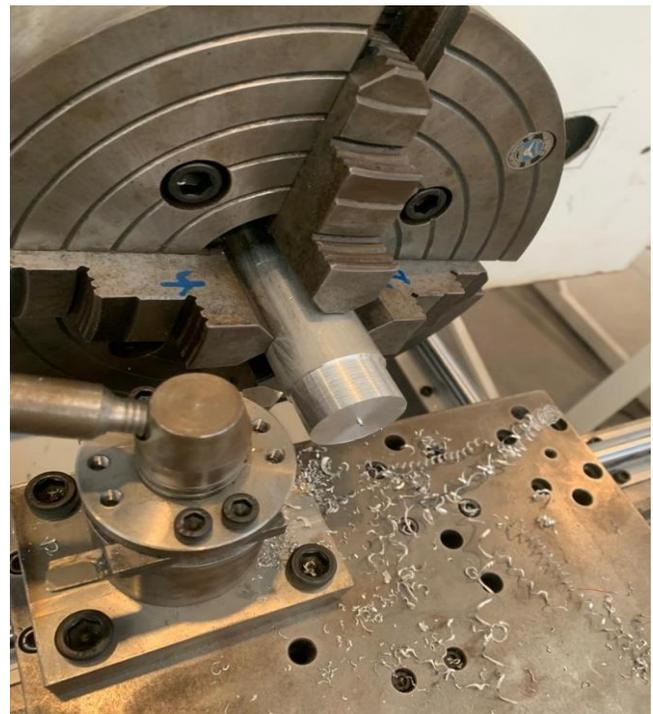
Fig. 20. Operación de cilindrado en aluminio 6061 de 1-1/2".
