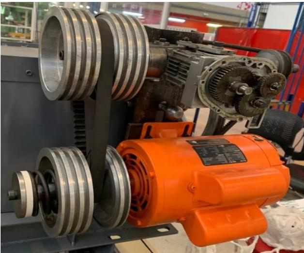
Fig. 14. Transmisión constantemente variable.
