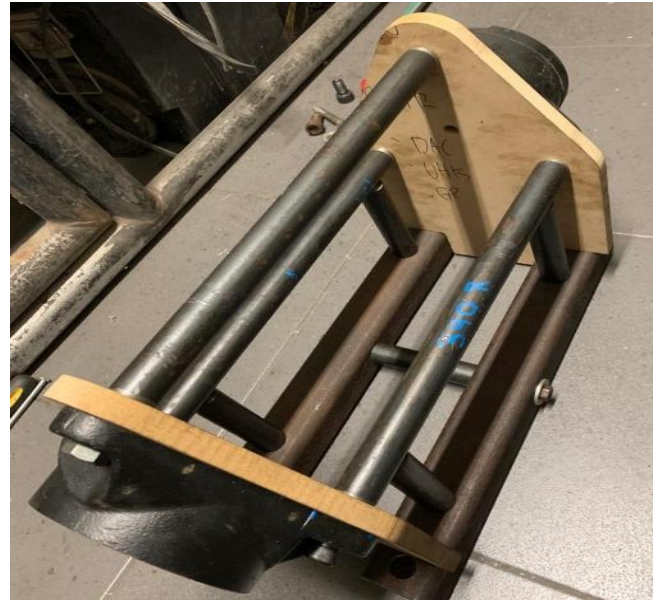
Fig. 10. Estructura interna alineada con patrón de MDF.
