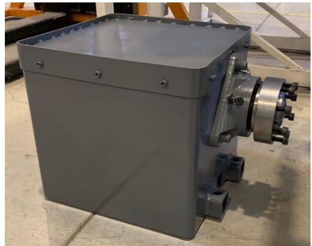
Fig. 11. Cabezal terminado con chumaceras y eje.
