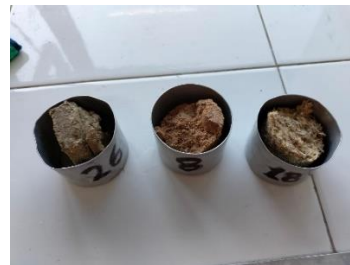
Fig. 8. Briquetas para prueba de materia volátil
