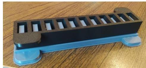
Fig. 27: Molde para soft robot.
