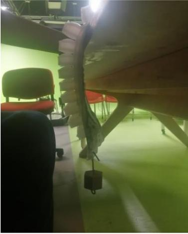
Fig. 34: Soft robot cargando una pesa de 60 g
