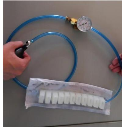
Fig. 32: Conexión manómetro.
