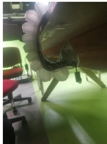
Fig. 34: Soft robot cargando una pesa de 5g
