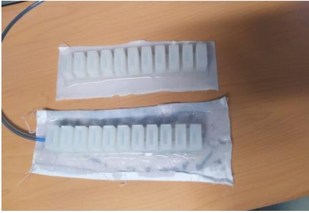
Fig 29. Modelos de soft robot realizados (modelo superior curado a temperatura ambiente, modelo inferior curado en horno Mufla)
