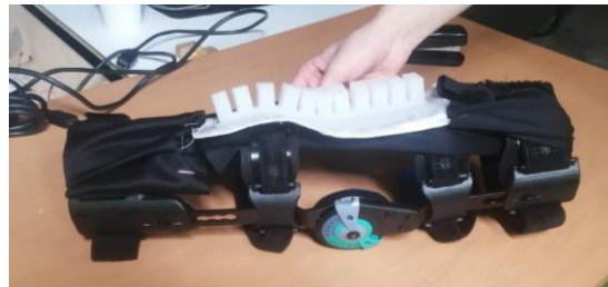
Fig. 37: Soft robot atado a la órtesis por medio de la tela lycra
