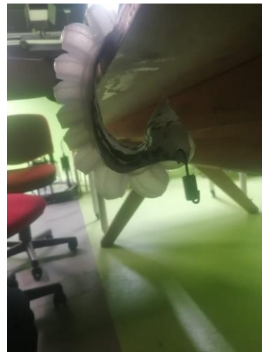
Fig. 34: Soft robot cargando una pesa de 5g
