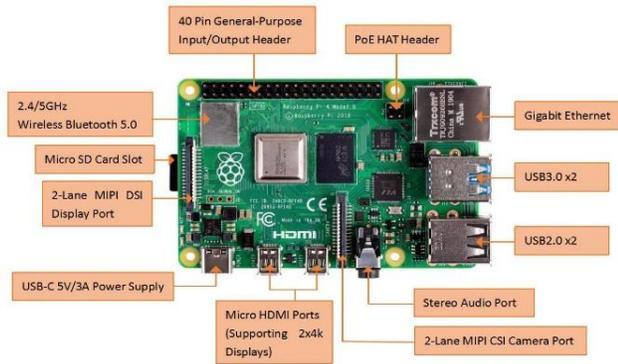
Fig. 1. Diagrama de la Raspberry Pi 4 Modelo B.
