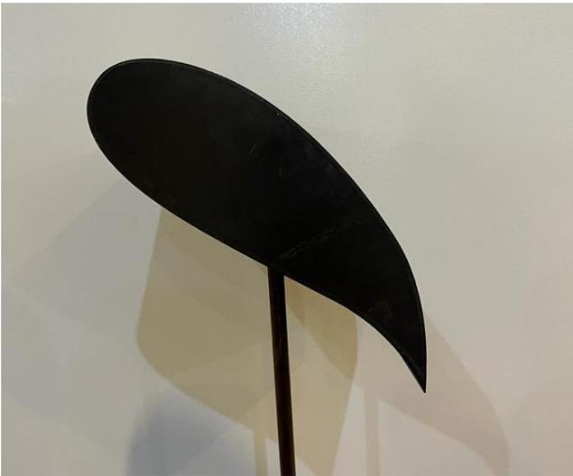
Fig. 17 Perfil alar con ángulo de ataque de 45°.
