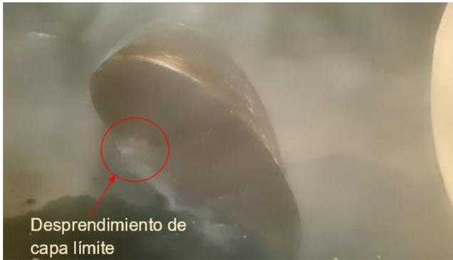
Fig. 21 Localización del desprendimiento de capa límite en el perfil alar con ángulo de ataque a  $45^\circ$
