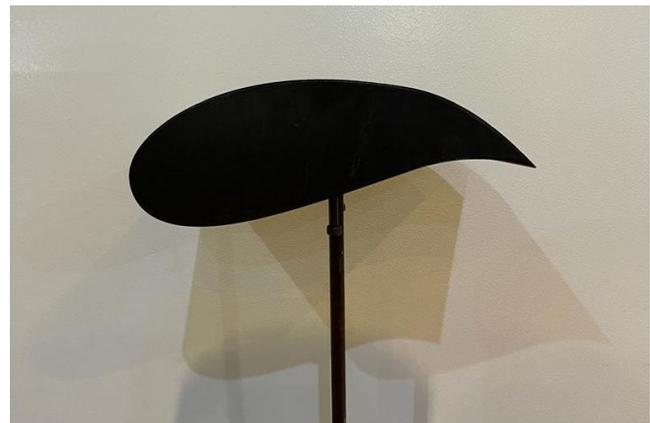
Fig. 10 Perfil alar con ángulo de ataque de  $0^\circ$ .
