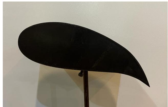
Fig. 15 Perfil alar con ángulo de ataque de 22.5°.
