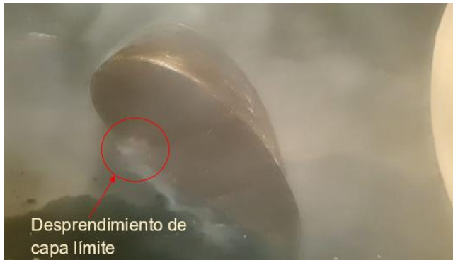
Fig. 21 Localización del desprendimiento de capa límite en el perfil alar con ángulo de ataque a 45°
