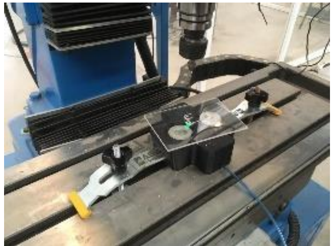
Fig. 15. Prueba de grabado de Acrílico en la fresadora OR-40.
