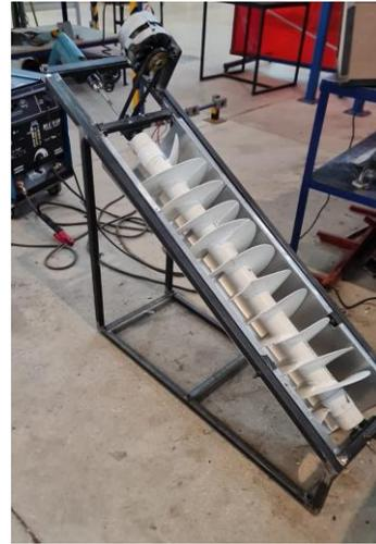
Fig. 3. Tornillo de Arquímedes.
