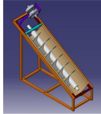
Fig. 6. Ensamble generador por tornillo de Arquímedes.
