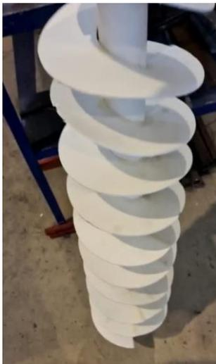
Fig. 2. Tornillo de Arquímedes.
