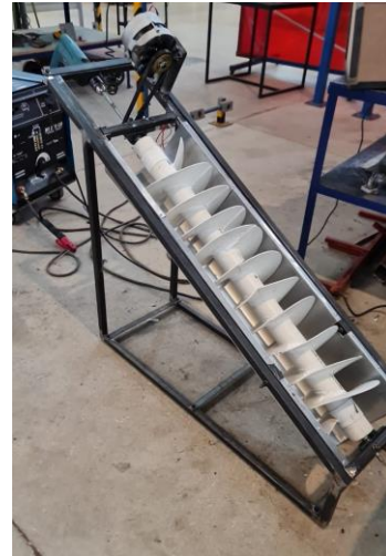
Fig. 3. Tornillo de Arquímedes.
