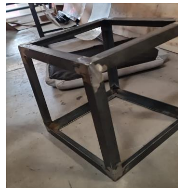
Fig. 8. Estructura de estación de carga
