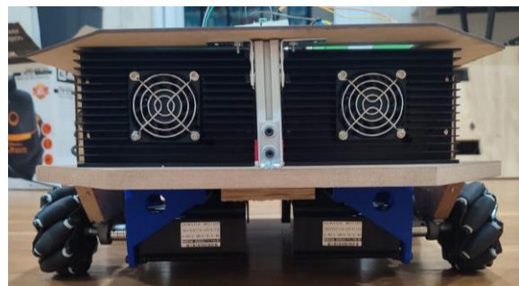
Fig. 7. Distribución estructura interna (placas, llantas, motores y drivers).
