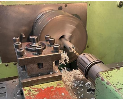
Fig. 11. Perforación del centro con broca de 7mm.
