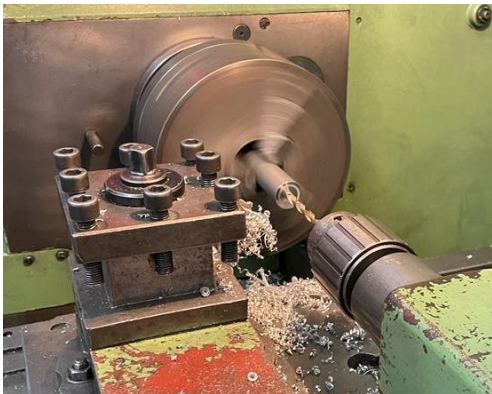
Fig. 11. Perforación del centro con broca de 7mm.
