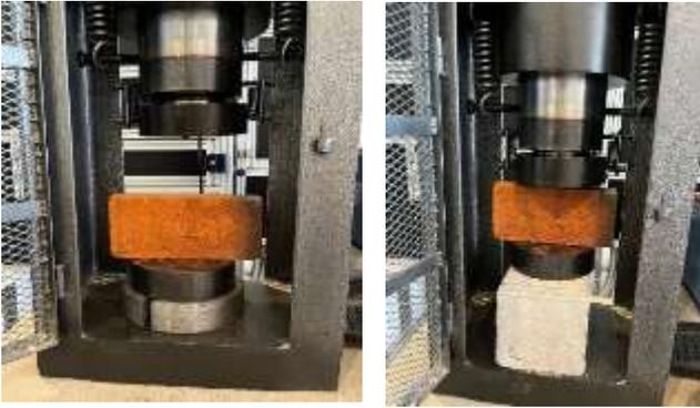
Fig. 1: Posición del ladrillo en la prensa hidráulica.
