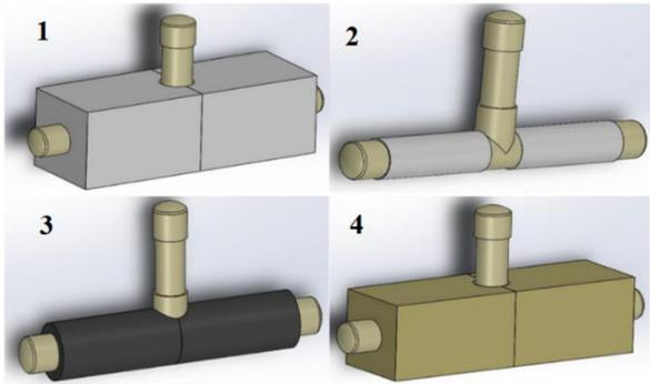
Fig. 4 Render de cada tubería con su respectivo termoaisilante elaborado en SolidWorks. 1. Poliestileno expandido. 2. Fibra de vidrio. 3. Polietileno. 4. Espuma de poliuretano.
