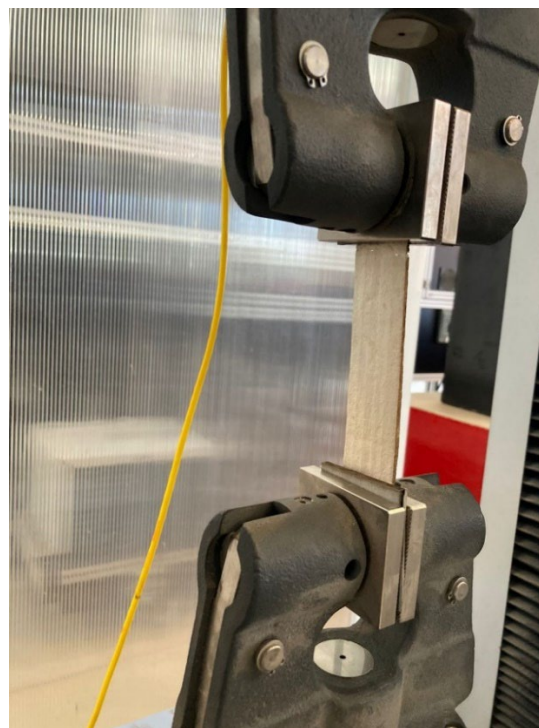
Fig. 4. Prueba de Tracción de probeta 100% CB - Liofilizado
