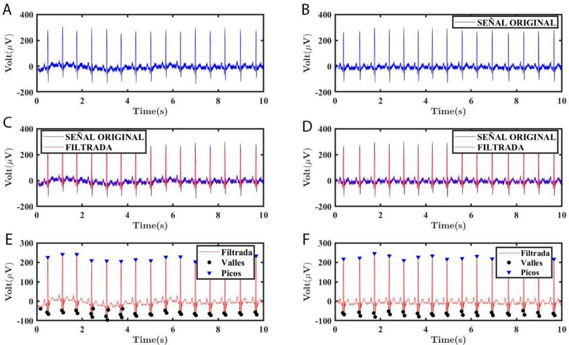
Fig. 13. Gráficas A y B: señales captadas por el prototipo de electrocardiografo, siendo la primer señal del paciente y la segunda respectivamente. Gráficas C y D: Comparativa de dos señales aplicando un filtro. Gráfica E yF: Comparativa de dos señales filtradas en las que se identifican los valles y los picos correspondientes a el complejo QRS del electrocardiograma.
