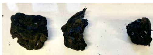
Fig. 18. Muestras de espuma Ibero tras la combustión total. Fuente: elaboración propia.
