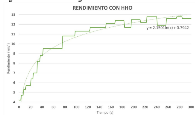
Fig. 3. Rendimiento de la gasolina con gas HHO inyectado en km/l.
