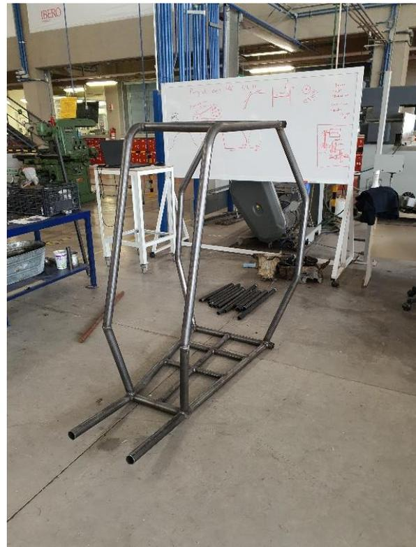
Fig. 13. Caja antivuelco completada.
