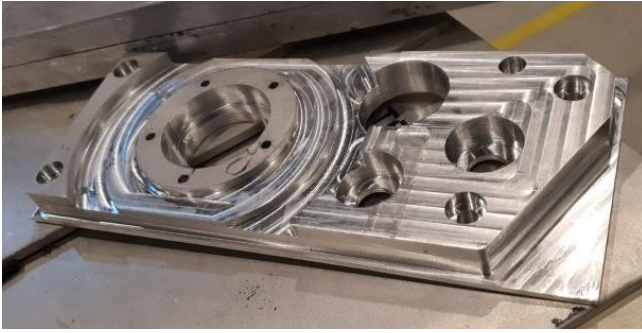
Fig. 21. Placa lateral de la transmisión maquinada en CNC
