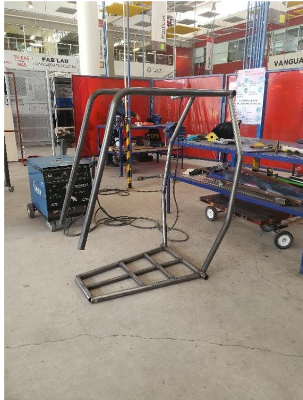
Fig. 12. Parte superior de la caja antivuelco completada.
