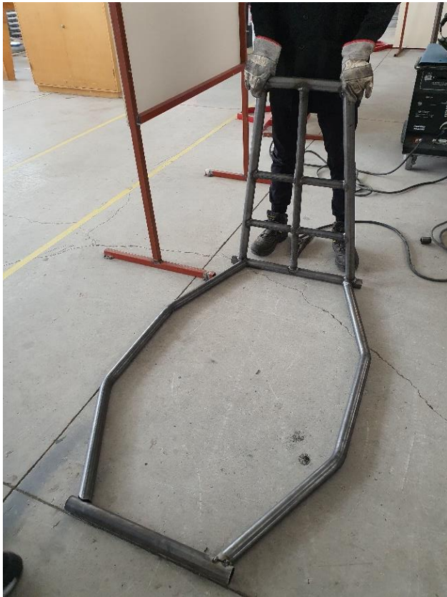
Fig. 11. Roll Hoop (abajo) y miembros que conforman el suelo del vehículo (arriba).
