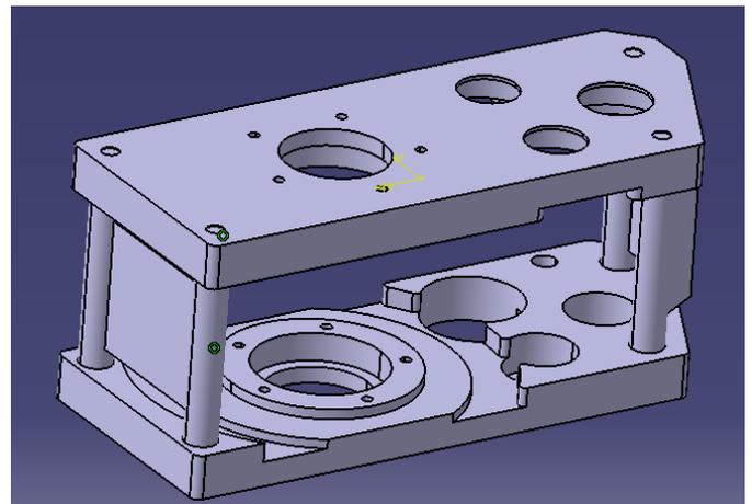
Fig. 4. Ensamble de la transmisión sin engranes.
