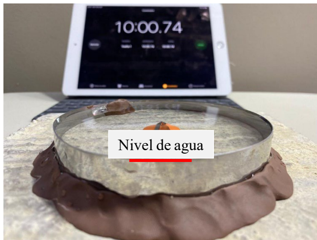
Figura 2. Prueba de permeabilidad en placa de concreto. La imagen nos muestra el término de la prueba en la que podemos observar que el nivel del agua se mantuvo hasta el tope del cono.
