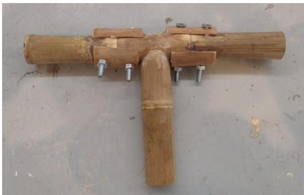
Fig. 12. Conexión atornillada en T. Elaboración Propia.
