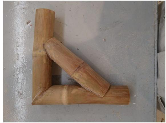
Fig. 13. Conexión en esquina. Elaboración Propia.
