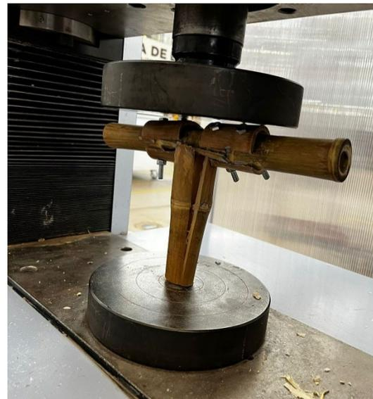
Fig. 9. Prueba a carga vertical de la conexión atornillada en T.
