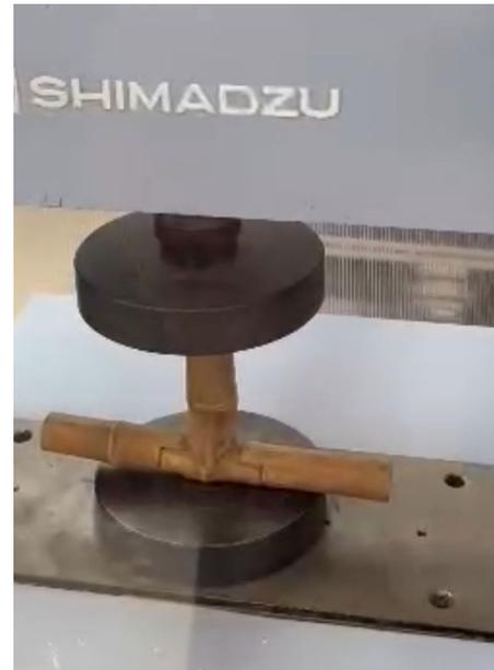
Fig. 8. Prueba a compresión de la conexión encajada en T.
