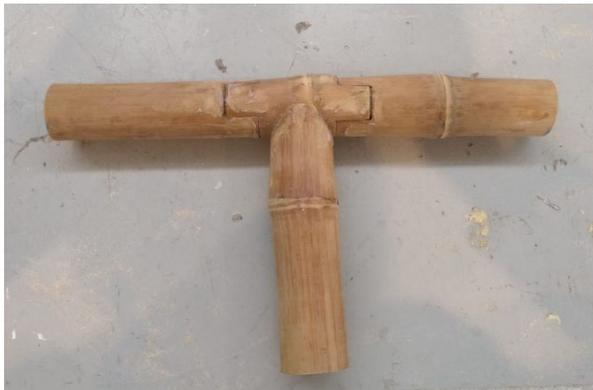
Fig. 11. Conexión encajada en T. Elaboración Propia.
