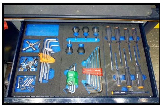
Ilustración 45, aplicación de 5'S en carrito de herramientas. Fuente, elaboración propia del alumno.
