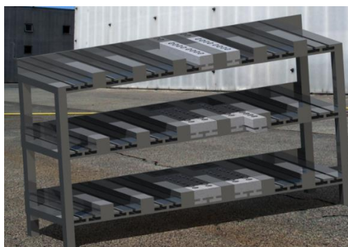
Ilustración 23 Propuesta de almacén de troqueles. Diseño propio
