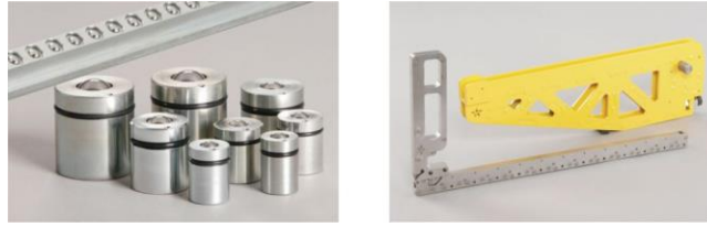
Ilustración 31 Lifters y escuadra de sujeción [23]
