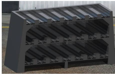
Ilustración 24 Propuesta 2 de almacén de troqueles. Diseño Propio
