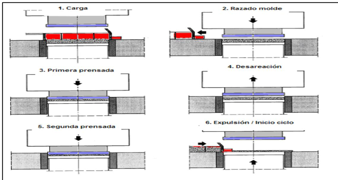
Figura 8 - Proceso de prensado en seco. Fuente (Keramika, 2016)
