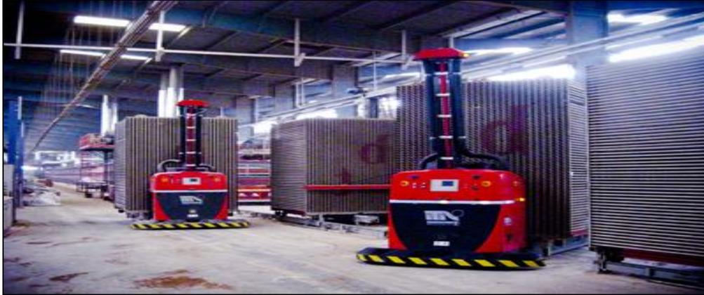
Figura 48 - Transporte de contenedores mediante LGV's. Fuente (Lamosa 2016)
