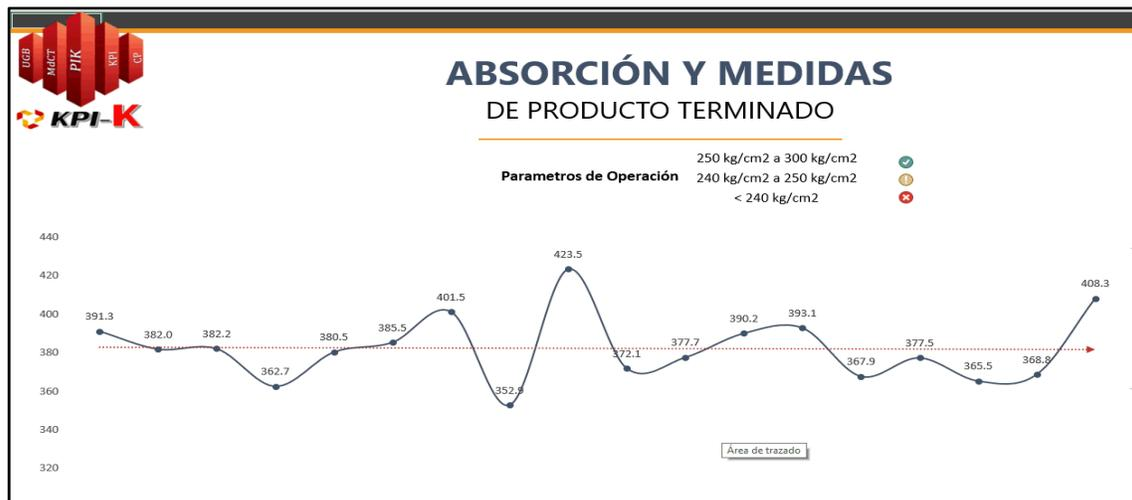
Figura 39 - Modulo de rotura en kg/cm<sup>2</sup>, formato 20x90cm. Fuente: Elaboración propia.
