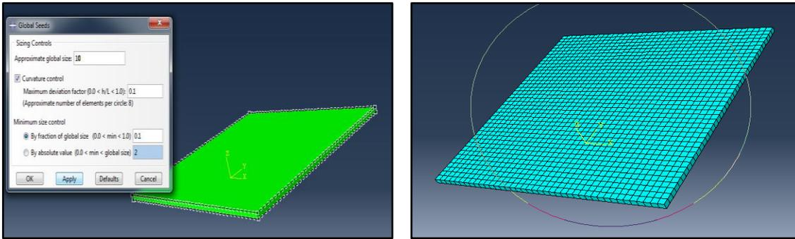
Figura 33 - Mallado del modelo. Fuente: Elaboración propia
