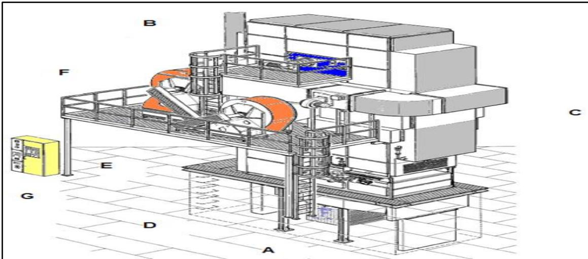
Figura 9 - Secador de tipo vertical. Fuente (Keramika, 2016)
