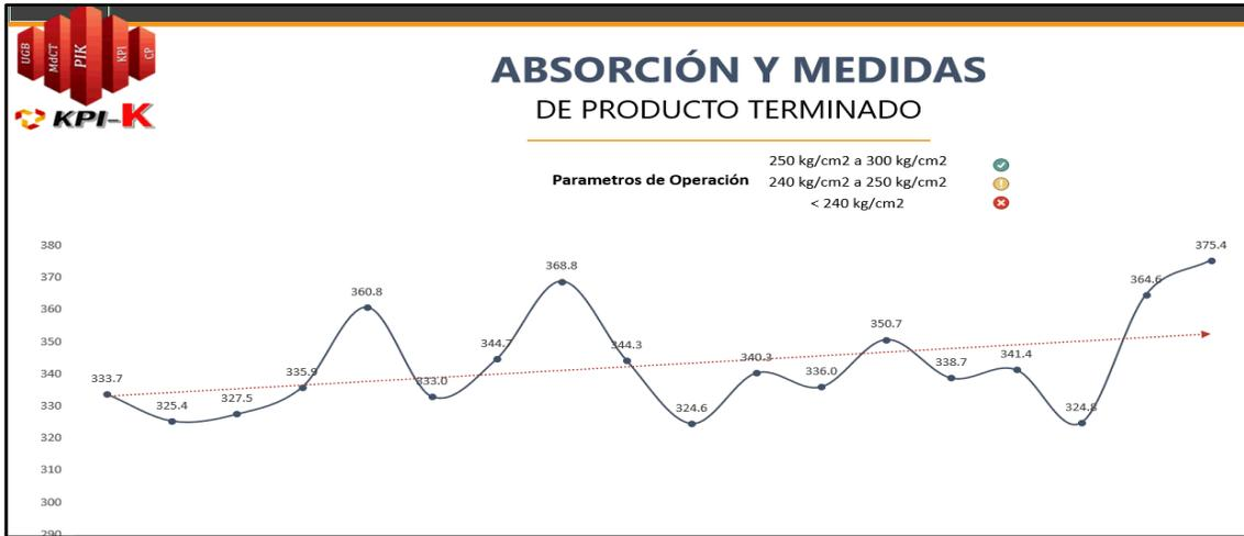
Figura 40 - Modulo de rotura en kg/cm<sup>2</sup>, formato 18x55cm. Fuente: Elaboración propia.
