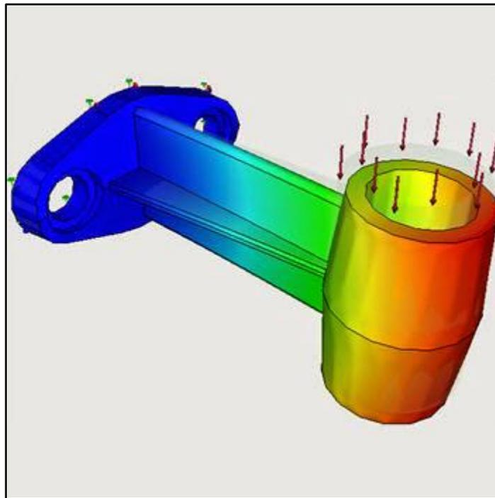
Figura 21 – Análisis estático mediante FEA (Arias F. Sergio, 2015).
