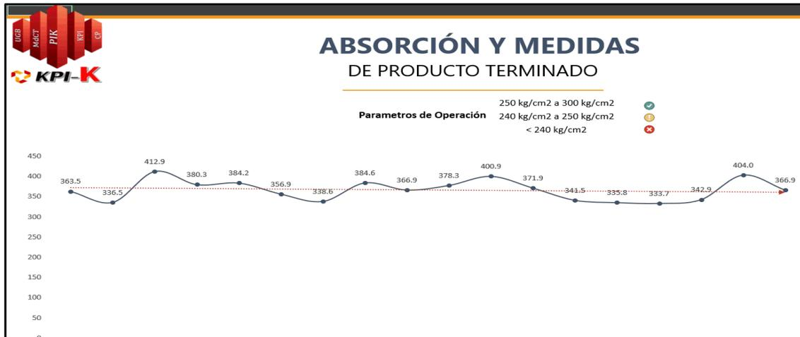
Figura 41 - Modulo de rotura en kg/cm<sup>2</sup>, formato 40x40cm. Fuente: Elaboración propia.
