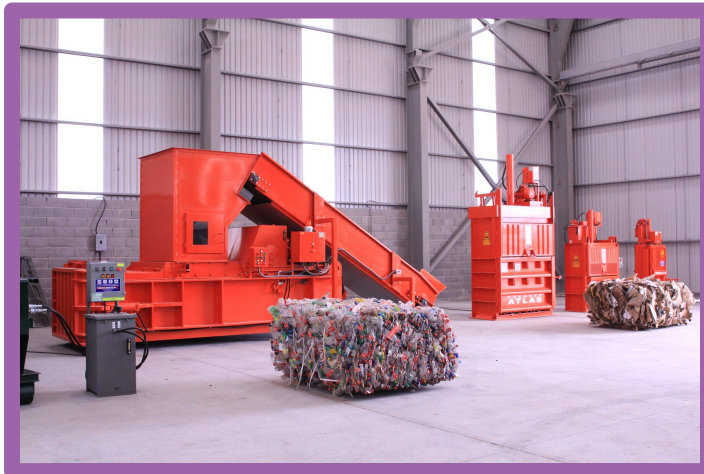
Figura 34: IMMSA. (2018). Prensas compactadoras verticales y horizontales . Recuperado de: https://www.facebook.com/IMMSAMVA/posts/2213930645315819/
