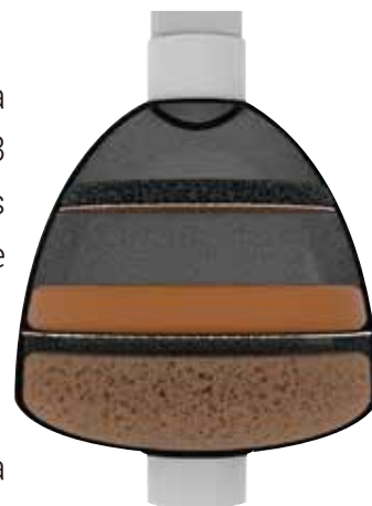
Imagen de elaboración propia 4. Segunda parte de interior del filtro con materiales
