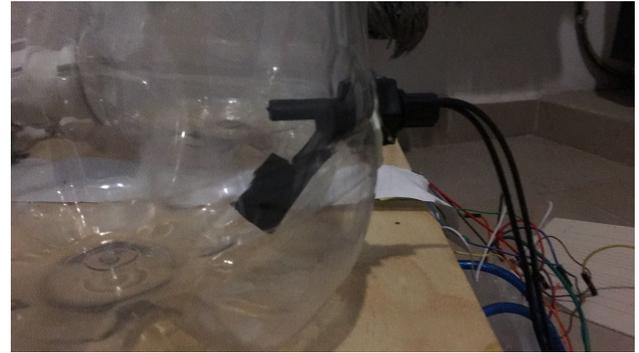
Ilustración 4. Posición del flotador cuando el recipiente está vacío.
