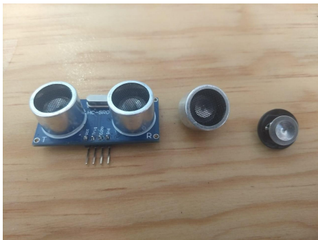
Fig. 4. Sensor ultrasónico de distancia del cual se extrajo el piezoeléctrico.
