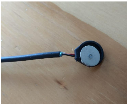
Fig. 3. Piezoeléctrico emisor de ultrasonido introducido en la cápsula.
