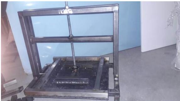
Foto 2. Prensa de termoformado terminada.
