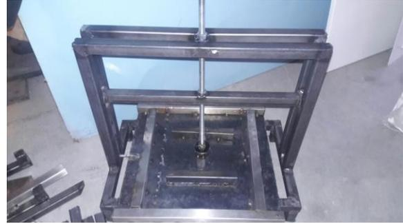
Foto1. Prensa de termoformado terminada.
