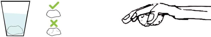
Por último será necesario verificar la solidez de la masa, por lo que se deberá hacer un rollo de la mezcla y colocarlo en cantiliver para comprobar su resistencia.
