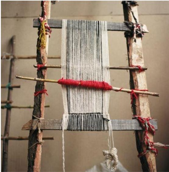
Dicho telar consiste en dos barras de madera ancladas en el suelo y dos barras transversales, en donde se sujeta la urdimbre, dichos hilos son separados por una barra de separación y una varilla de lizos.
