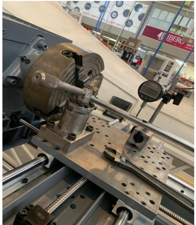
Fig. 16. Alineación de cabezal en el eje vertical con medidor de carátula.
