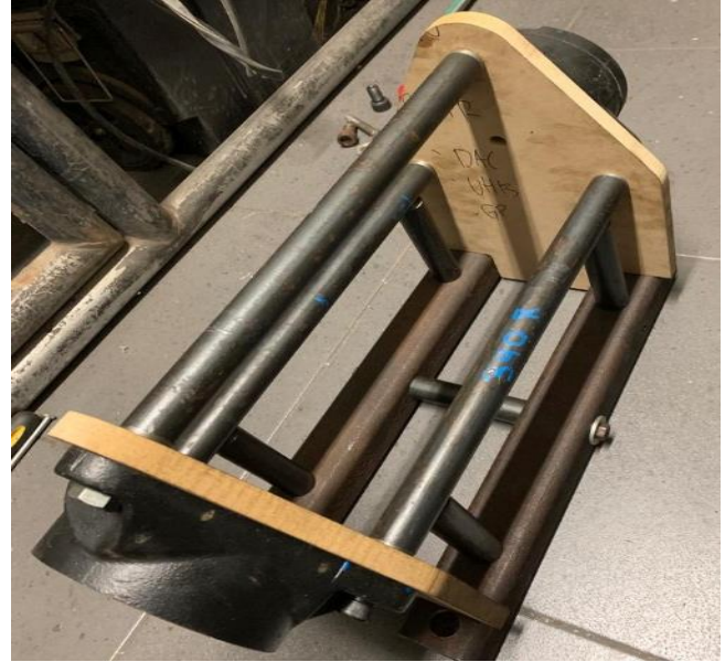
Fig. 10. Estructura interna alineada con patrón de MDF.
