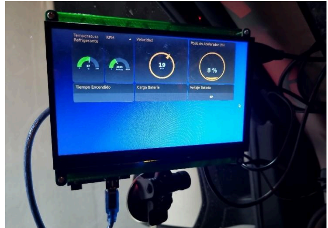
Fig.16. Clúster digital montado, evidenciando parámetros del vehículo.
