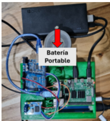
Fig.15. Clúster energizado con batería portátil.
