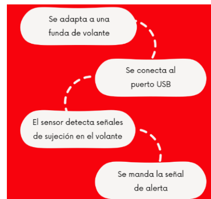
Fig. 13. Diagrama de funcionamiento de sistema de alerta de fatiga
