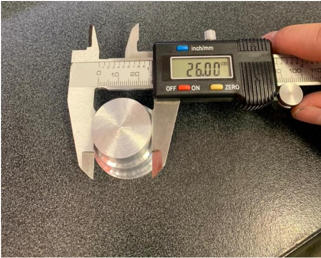
Fig. 21. Operación de cilindrado realiza en aluminio a 26 mm.
