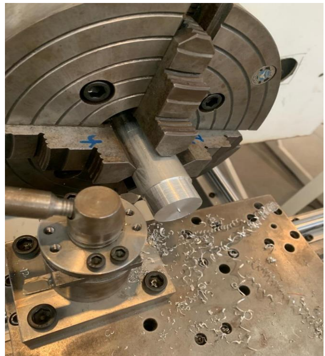
Fig. 20. Operación de cilindrado en aluminio 6061 de 1-1/2".
