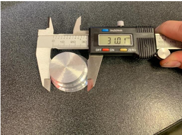
Fig. 22. Operación de cilindrado realiza en aluminio a 31 mm.
