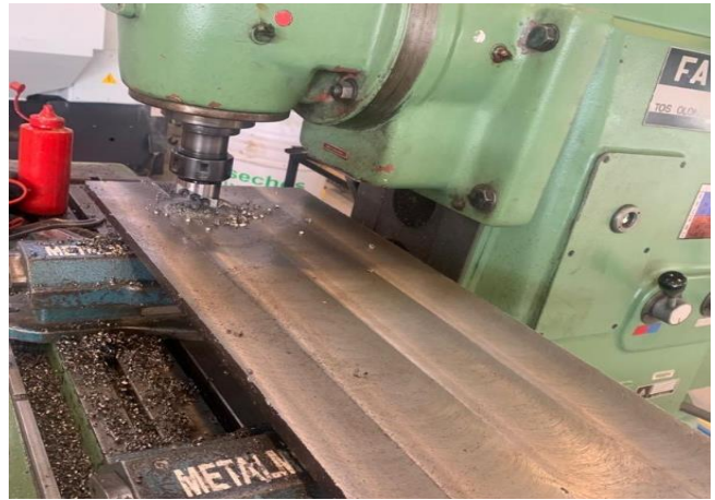
Fig. 5. Rectificado de zona superior del carro con fly cutter .
