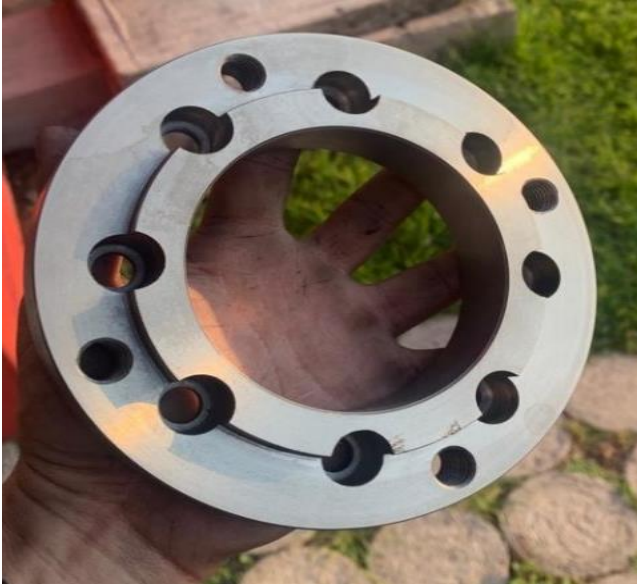
Fig. 13. Placa adaptadora de barrenos de eje a barrenos de chuck.
