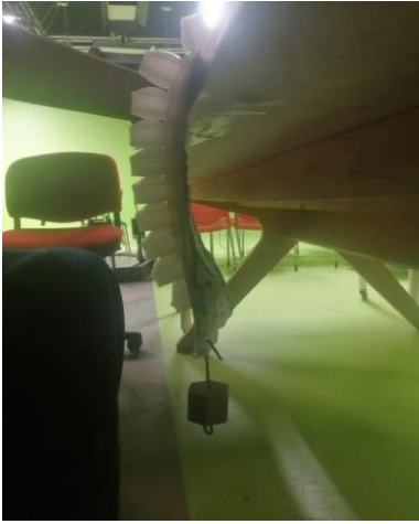
Fig. 34: Soft robot cargando una pesa de 60 g
