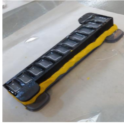
Fig. 6: Molde con mezcla de silicona.
