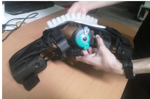
Fig. 38: Órtesis flexionada con el soft robot quedándose en el codo correctamente.
