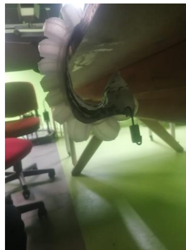
Fig. 34: Soft robot cargando una pesa de 5g
