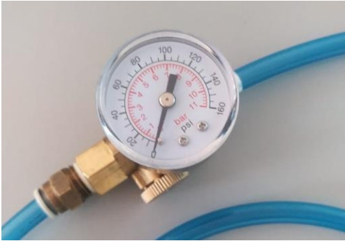
Fig. 12: Válvula ajustadora de aire con manómetro
