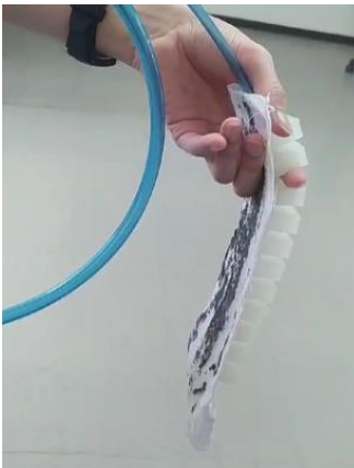
Fig. 30: Conexión válvula y cable en el soft robot.
