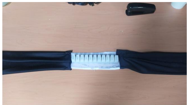
Fig. 16: Soft robot atado a la tela lycra
