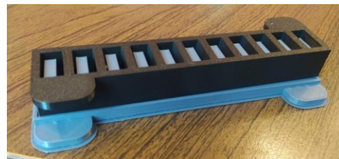
Fig. 27: Molde para soft robot.
