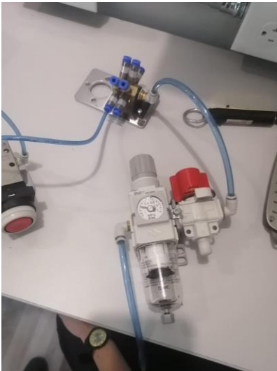
Fig. 13: Válvula ajustadora de aire con manómetro
