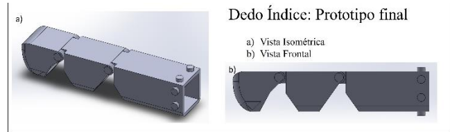
Fig. 4. Diseño final dedo índice basado en medidas antropométricas realizado en SolidWorks.
