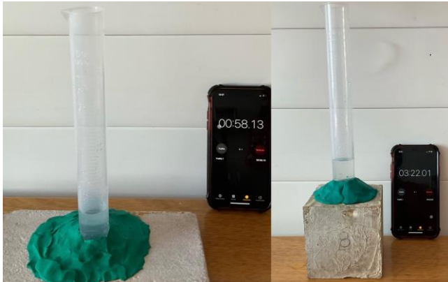
Fig. 7. Prueba de permeabilidad en mortero y petatillo.
