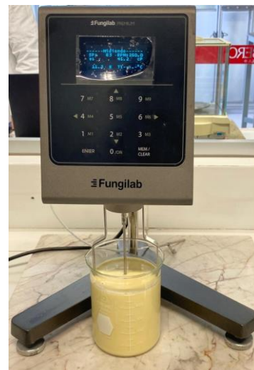
Fig. 3. Determinación de viscosidad con viscosímetro.
