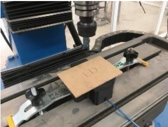
Fig. 13. Prueba de grabado de Madera MDF en la fresadora OR-40.
