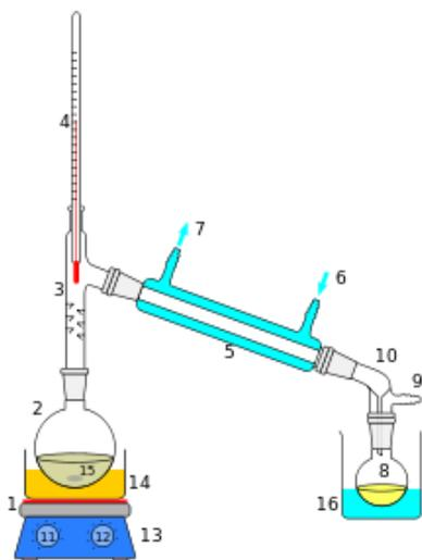
Fig 2. Proceso de destilación del ácido cítrico.
