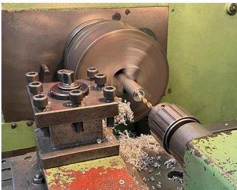
Fig. 11. Perforación del centro con broca de 7mm.
