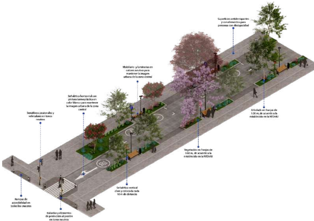
Imagen No. 13. Planta isométrica esquemática, corredores de prioridad peatonal, calle 16 de Septiembre
