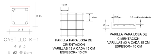
Fig. 1. Detalles del diseño de la cimentación de la planta de lombricompostaje. Elaboración propia (2022).
