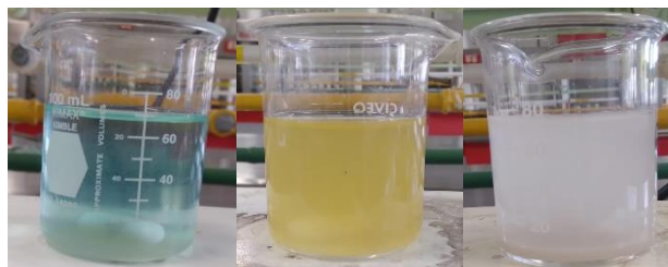
Fig. 11. Soluciones con pectina. a) Cu, b) Cr, c) Pb. Fuente: Elaboración propia.
