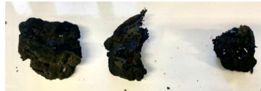
Fig. 18. Muestras de espuma Ibero tras la combustión total. Fuente: elaboración propia.
