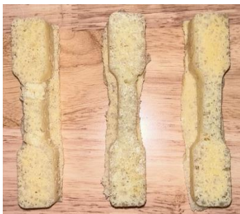
Fig. 3. Probetas de espuma Ibero prueba de tensión. Fuente: elaboración propia.
